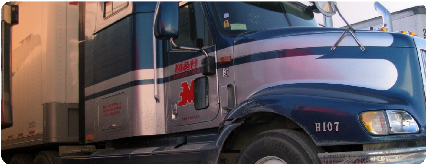
Figura 2. Además de una buena aerodinámica en el tractor, la correcta distancia entre este y el semirremolque permite reducir las pérdidas por resistencia aerodinámica. En la figura se muestra un ejemplo donde la distancia entre ambos elementos se ha optimizado para reducir el consumo de combustible.
